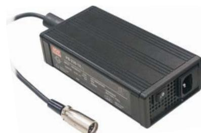
denia s tichou prevádzkou s 3 fázovou dobíjacou charakteristikou určená pre akumulátorové banky a akumulátory s kapacitou 80-200 Ah (12 V), 40-125 Ah (24 V), 20-65 Ah (48 V). Nabíjačka má zvoliteľnú pasívnu funkciu PFC s minimálnym odberom bez záťaže < 3,5 mA/240VAC. Napríklad do akumulátora 24 V je zdroj schopný dodať dobíjací prúd 10,5 A.
